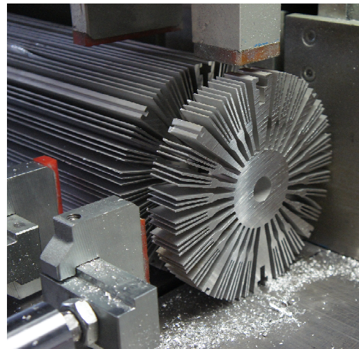
FOTO DI ESEMPIO: SI ESEGUONO OPERAZIONI DI TAGLIO A MISURA SU PROFILI IN ALLUMINIO
